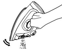
9. Pour empêcher la corrosion des événements de la semelle, brancher dans une prise secteur de 120 V c.a., placer le fer à la position verticale, régler le sélecteur de température sur « **MAX** » et préchauffer le fer pendant 5 minutes.
