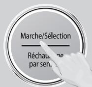
Appuyer sur le sélecteur pour mettre l'appareil en **marche**; le compte à rebours de la minuterie différée s'amorce, puis la cuisson débute.
