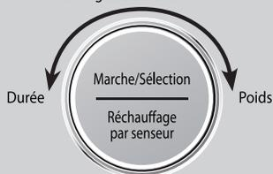
Pour permettre le fonctionnement du programme automatique, s'assurer que le four est en mode Horloge. Sélectionner le menu désiré en tournant le sélecteur. Appuyer sur le sélecteur pour confirmer le programme.
