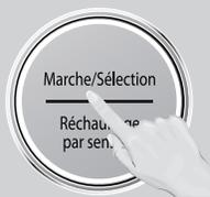
Appuyer sur le sélecteur pour préchauffer le four. L'indication « PRÉCHAUFFAGE » défile une fois à l'écran, un « P » s'affiche ensuite. Quand le préchauffage est terminé, le four émet un bip et l'indication « P FIN » s'affiche à l'écran.
