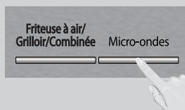
Certaines recettes nécessitent une durée d'attente en fin de cuisson. Appuyer sur **Micro-ondes** jusqu'à ce que le niveau désiré de puissance s'affiche à l'écran. 1 000 W est le niveau le plus élevé et 100 W, le plus faible.
