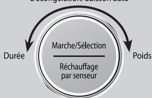
Pour permettre le fonctionnement du programme automatique, s'assurer que le four est en mode Horloge. Sélectionner le menu désiré en tournant le sélecteur.
