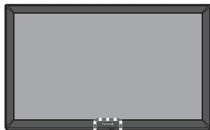
Capteur de signal de télécommande
