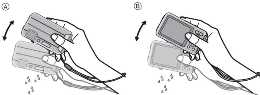
**3** Essuyez les gouttelettes d'eau sur le boîtier de l'appareil avec un linge doux et sec, puis laissez l'appareil sécher dans un endroit ombragé, bien aéré.
