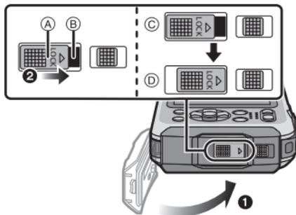
**N'ouvrez pas et ne fermez pas le couvercle latéral dans un endroit sablonneux ou poussiéreux, près d'un plan d'eau ou avec les mains mouillées. L'adhérence de sable ou de poussière pourrait miner l'étanchéité et permettre l'infiltration d'eau.**
