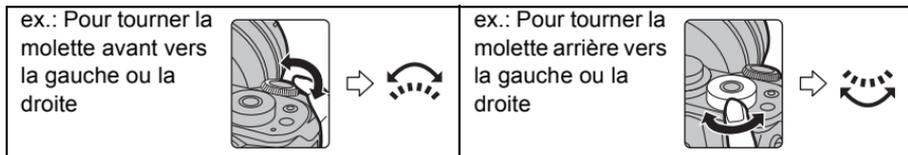
Vous permet de définir l'ouverture, la vitesse d'obturation, et les autres paramètres pour les modes **P / A / S / M**.
