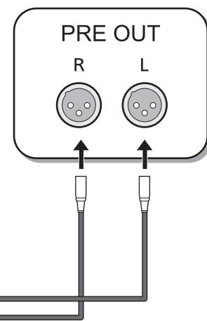
\*1 Sélectionnez [BALANCED] ou [UNBALANCED]. Réglez le commutateur de sélection d'entrée audio sur une position qui correspond au dispositif que vous souhaitez lire.
